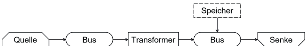
Abb. 1: Grafik eines einfachen Energiesystems, bestehend aus einer Quelle, zwei Bussen, einem Transformator, einem Speicher und einer Senke [16].
