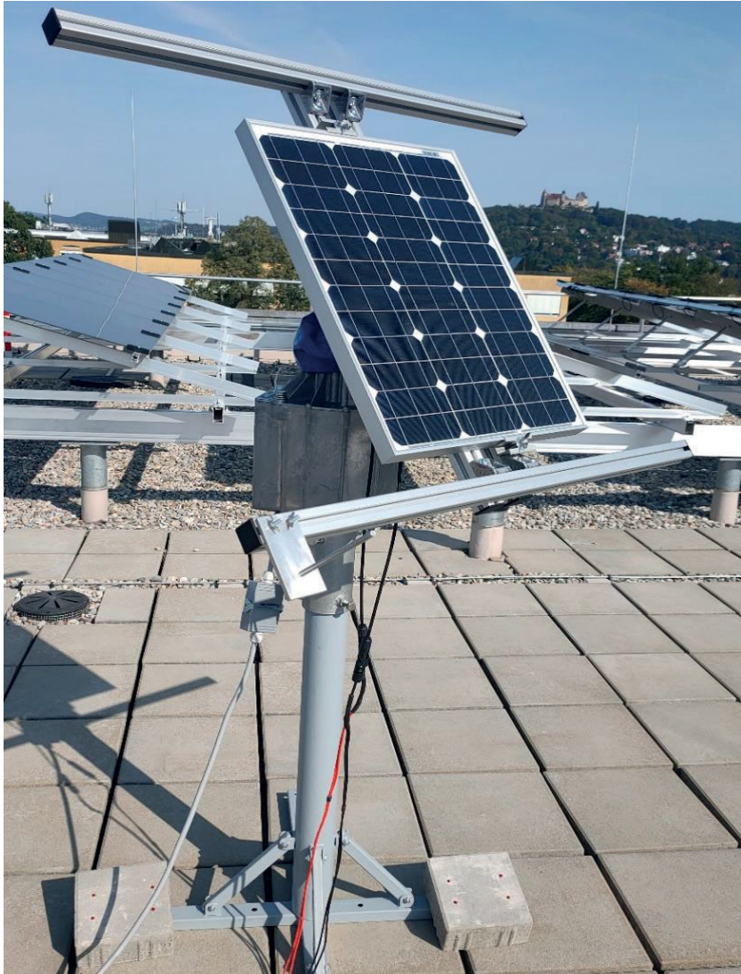
Abb. 2: Foto des mobilen Trackersystems für PV-Module verschiedener Maße
