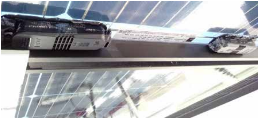
Abb. 15: Optimierung von verschattenden Anschlussdosen, Rahmen und Bifazialität
