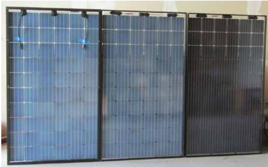
Abb. 12: Optimierungsschritte von verschattenden Anschlussdosen, Rahmen und Bifazialität
