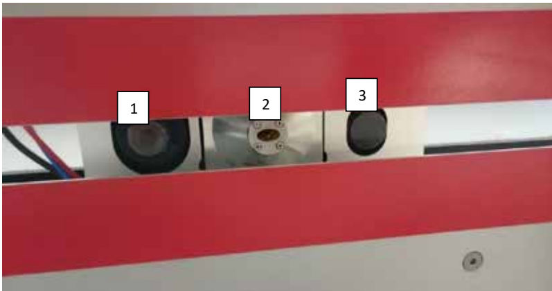
Abb. 2: Sensoreinheit, Temperatursensoren vorn (1) und hinten (2), Heizlampe (3) in der Mitte
