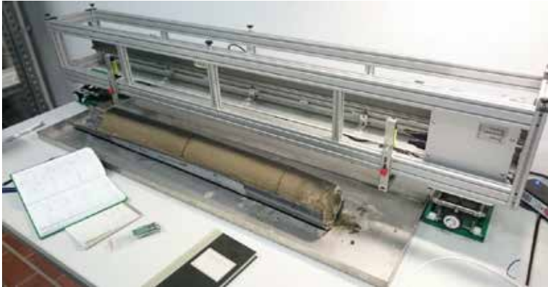
Abb. 1: TCS Überkopfkonfiguration für die Messung eines Lockersedimentbohrkerns
