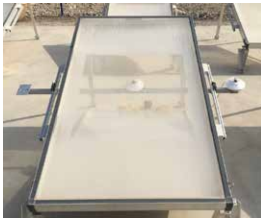
Abb. 4: Die zwei Pyranometer werden auf einem Arm montiert und an einer Haltvorrichtung am Rahmen fixiert
