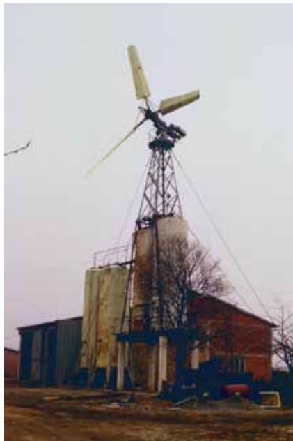
Abb. 4: vom Landwirt im Selbstbau hergestellter Windgenerator auf dem Futtersilo eines landwirtschaftlichen Betriebes, um 1980 (Foto: Bruno Spessert)
