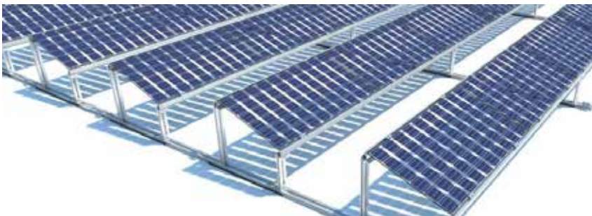
Abb. 3: Skizze aufgeständerte bifaziale PV Module auf Flachdach (Quelle: Opsun, USA)
