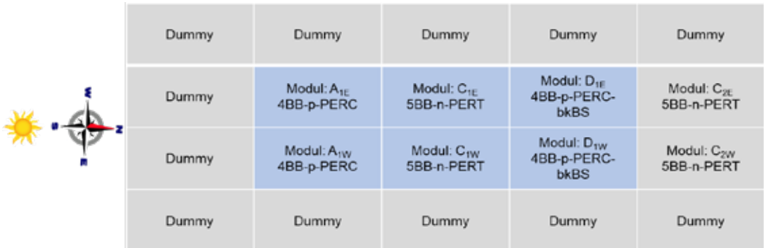
Abb. 13: Skizze vom Aufbau der bifazialen Testanlage
