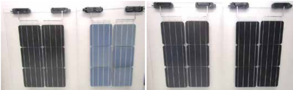
Abb. 6c: links –PERC Technologie vorne und hinten; rechts – PERT Technologie vorne und hinten
