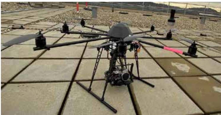
Abb. 1: Oktocopter mit IR- und Tageslichtkamera der HS-Coburg
