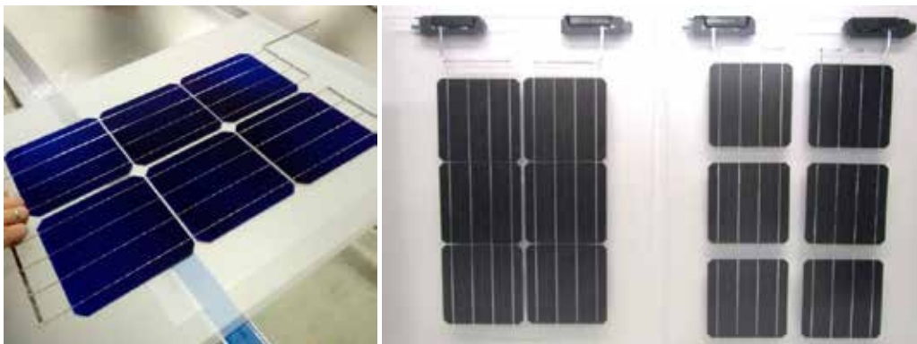
Abb. 6a: links – Herstellung 6er Modul; rechts – Variation Zellabstand
