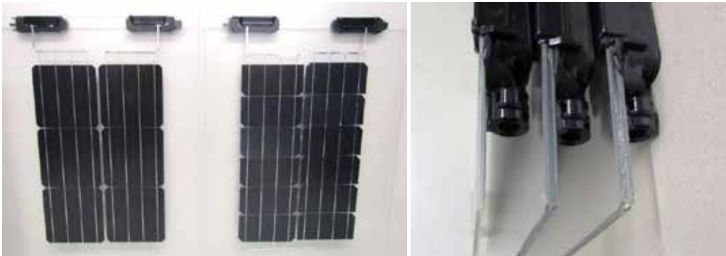
Abb. 6b: links – Variation ganze oder halbe Zellen; rechts – Variation Glasdicke
