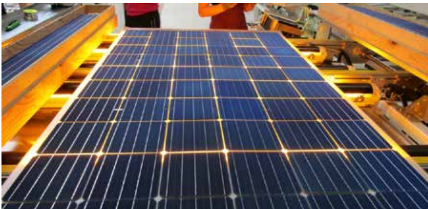
Abb. 8: Bau der bifazialen 60-Zell-Module in der Fertigungslinie
