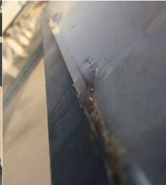
Abb. 6: Dabei nehmen diese Tropfen Staub und andere Partikel auf und transportieren diese an den unteren Rand des Kollektorrahmens, wo sie nach dem Verdampfen des Wassers verbleiben
