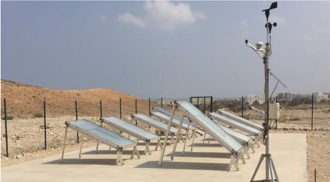
Abb. 2: Übersicht des Versuchsfeldes mit acht unterschiedlichen Kollektorabdeckungen mit Rahmen und der Wetterstation mit Sensoren für relative Luftfeuchte, Temperatur, Windrichtung und Windstärke und Globalstrahlung
