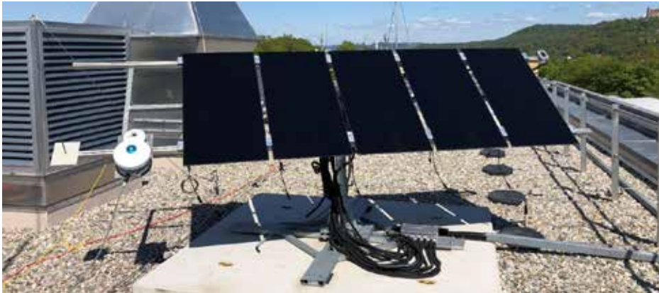
Abb. 5: Stationärer 2-Achsiger-Modultracker der HS-Coburg mit Pyranometer und Spektrometer in Modulebene
